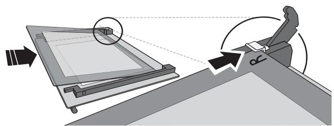
**4.** Επανατοποθετήστε την άνω γωνία: ένα κλίκ δείχνει ότι τοποθετήθηκε σωστά. Βεβαιωθείτε ότι η τσιμούχα είναι καλά σταθεροποιημένη πριν επανατοποθετήσετε την πόρτα.
