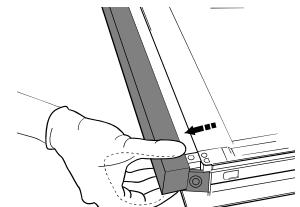
**2.** Σηκώστε και κρατήστε σταθερά το εσωτερικό τζάμι και με τα δύο χέρια, αφαιρέστε το και τοποθετήστε το σε μια μαλακή επιφάνεια πριν το καθαρίσετε.
