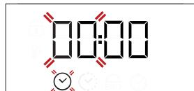
Χρησιμοποιήστε το + ή το - για να ρυθμίσετε την ώρα και πατήστε το ☰ για επιβεβαίωση. Τα δύο ψηφία των λεπτών θα αρχίσουν να αναβοσβήνουν. Χρησιμοποιήστε το + ή το - για να ρυθμίσετε τα λεπτά και πατήστε το ☰ για επιβεβαίωση.
