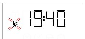
Σημείωση: Κατά τη διάρκεια ψησίματος μπορείτε να αλλάξετε λειτουργία γυρίζοντας το κουμπί επιλογής ή να ρυθμίσετε τη θερμοκρασία γυρίζοντας τον επιλογέα θερμοστάτη. Η λειτουργία δεν ξεκινάει αν το κουμπί θερμοστάτη είναι ενεργό ●. Μπορείτε να ρυθμίσετε το χρόνο ψησίματος, το χρόνο τέλους ψησίματος (μόνο εάν ρυθμίσετε το χρόνο ψησίματος) και το χρονοδιακόπτη.
